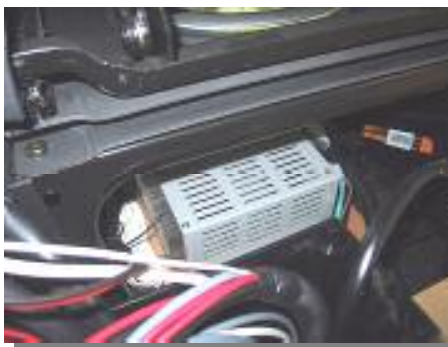
ALIMENTEUR-CHARGEUR DE BATTERIE
