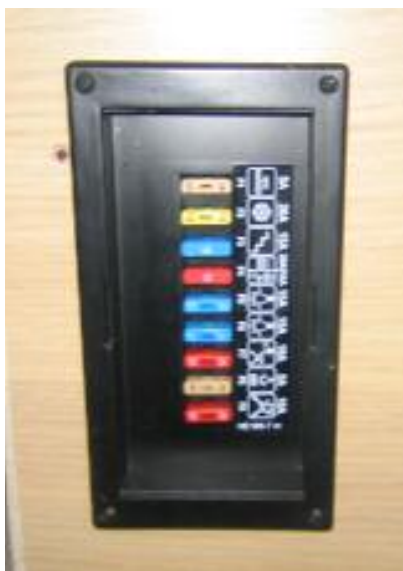
PORTE-FUSIBLES INTÉGRÉ AU MOBILIER
