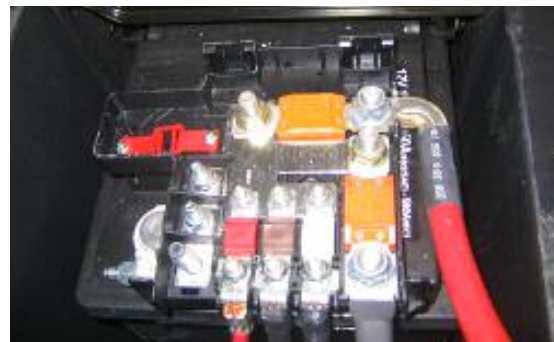
PHOTO E: Fusibles batterie chassis
