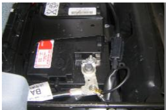
PHOTO D: Fusibles batterie chassis FORD
